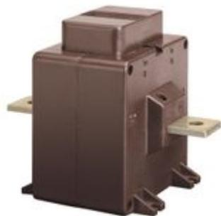
TAQ10P - Trasformatore di corrente monofase per protezione - Cavo/sbarra passante: primario avvolto - Rapporto: 15/5A - Classe: 5P5/5P10 - Prestazioni: 4/2 VA
