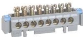
Morsettiere universali su supporto. Partenze 8. Lunghezza 75 mm. Fornite per l'impiego (viti aperte) 100 A maxi - 400 Vac con arrivi 25 mmq 80 A maxi - 400 V c. c. con arrivi 16 mmq. Si fissano principalmente su barrette 12 x 12 mm. Fornite con sigle Duplix (con indicazione di fase, neutro e terra)
