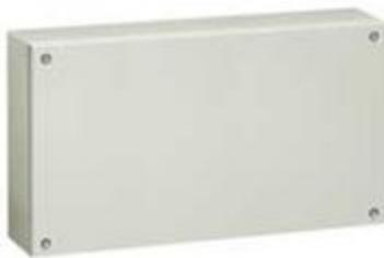
Cassette di derivazione metalliche 400 x 600 x 120 mm. Cassette in lamiera d'acciaio spessore 9/10um. Fissaggio del coperchio con viti antisfilamento. Verniciatura poliestere RAL 7035. Equipaggiate con 2 montanti verticali preforati Grado di protezione IP66 secondo EN 60529 e IK10 secondo EN 50102.
