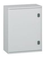
Quadro poliestere 820 x 610 x 300 mm. IP 66 secondo la norma IEC EN 60529 e IK 10 secondo IEC EN 62262 (EN 50102), Classe II(1). Poliestere rinforzato con fibre di vetro, autoestinguente a 960 °C secondo la norma IEC EN 60695-2-11. Adatto ad ambienti corrosivi. Porta reversibile, apertura a 180° con cerniere imperdibili. Serratura a doppia barretta. Fissaggio diretto degli equipaggiamenti sul fondo del quadro.
