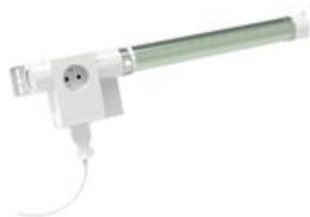
Kit di illuminazione a LED con spina e rilevatore di presenza. Colore RAL7035 - Classe I - Tecnologia LED - Regolabile 120° - IP20 - IK06 - 230V - da 50Hz a 60Hz Rilevatore di presenza appositamente progettato per l'uso in un quadro elettrico, tempo minimo di illuminazione fisso 6 min (funziona senza contatto porta) Precablati con cavo di alimentazione lunghezza 2m. Per quadri ed armadi Blizzard PRO, Altis, Atlantic e Marina con larghezza 600mm
