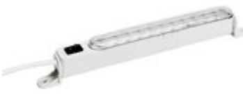
Kit di illuminazione a LED con interruttore, precablata con cavo di alimentazione lunghezza 2m. Colore RAL7035 - Classe II - Tecnologia LED - Regolabile 60° - IP20 - IK06 - 230V - da 50Hz a 60Hz. Per quadri ed armadi Blizzard PRO, Altis, Atlantic e Marina con larghezza 400mm. Fissaggio a vite con lingue di fissaggio in dotazione. Possibilità di fissaggio a vite diretta su Altis assemblato
