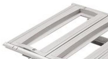
Pannello finestrato altezza 110 mm per telai modulari larghezza 300 mm, per quadri Atlantic-E, Atlantic inox e Marina. Pannelli in ABS e fibra di vetro - RAL 7035. Tenuta al calore anomalo: T = 750°C. Fissaggio su supporti con viti ad 1/4 di giro. Forniti con profilato EN 60715
