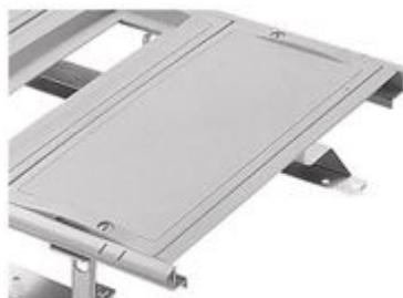
Pannello cieco altezza 150 mm per telai modulari larghezza 800 mm, per quadri Atlantic-E, Atlantic inox e Marina. Pannelli in ABS e fibra di vetro - RAL 7035. Tenuta al calore anomalo: T = 750°C. Fissaggio su supporti con viti ad 1/4 di giro
