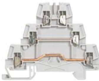
Morsetto a vite per sensori - 3 collegamenti 3 piani - sezione max = 2,5mmq - passo 6mm - colore grigio. Permette di raccordare due sensori (art. 0371 51) o azionamenti (art. 0371 52), con alimentazione comune grazie agli shunt articoli 0375 46/47
