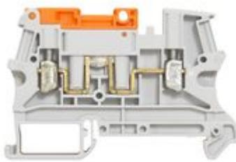
Morsetto a vite sezionabile per circuiti standard con minisezionatore - 1 collegamento - sezione max = 2,5 mmq - colore grigio - passo 6mm.
