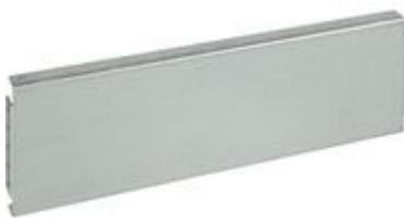
Piastra parziale 200 x 600 mm. In coordinamento con le porte parziali esterne e con il separatore verticale permettono la costruzione di celle IP20. Costruite in lamiera zincata spessore 20/10um, si fissano sui separatori orizzontali o sui montanti articolo 04803... Si montano direttamente sui separatori orizzontali o con l'aiuto delle traverse orizzontali e multifunzione
