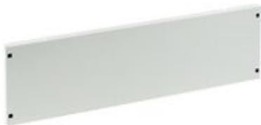
Piastra parziale 1400 x 600 mm. In coordinamento con le porte parziali esterne e con il separatore verticale permettono la costruzione di celle IP20. Costruite in lamiera zincata spessore 20/10um, si fissano sui separatori orizzontali o sui montanti articolo 04803... Si montano direttamente sui separatori orizzontali o con l'aiuto delle traverse orizzontali e multifunzione
