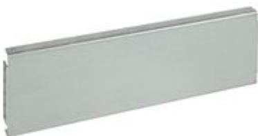
Piastra parziale 200 x 800 mm. In coordinamento con le porte parziali esterne e con il separatore verticale permettono la costruzione di celle IP20. Costruite in lamiera zincata spessore 20/10um, si fissano sui separatori orizzontali o sui montanti articolo 04803... Si montano direttamente sui separatori orizzontali o con l'aiuto delle traverse orizzontali e multifunzione
