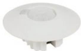
Sensore KNX da soffitto, infrarossi passivi (PIR), grado di protezione IP20. Ideale per l'installazione in aree di passaggio (es. atri, corridoi, ...) o aree di lavoro (es.uffici, sale riunioni,...). Connessione al bus tramite connettore KNX rosso/nero. Tensione di alimentazione SELV 29 Vd.c. da bus KNX. Installazione ad incasso nel controsoffitto o soffitto in muratura tramite molle o scatole da incasso; installazione superficiale a plafone tramite accessorio ref. 048875.
