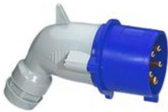
Spina mobile angolata 2P+T, IP44/IK09, In= 16A, Vn=200÷250Vac, blu. Bloccaggio del cavo e chiusura senza viti
