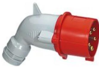
Spina mobile angolata 3P+T, IP44/IK09, In= 16A, Vn=380÷415Vac, rossa. Bloccaggio del cavo e chiusura senza viti
