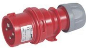
Spina mobile con inversione di fase 3P+N+T, IP44/IK09, In= 16A, Vn=380÷415Vac, rossa. Utilizzabile per cambiare la direzione di rotazione di un motore elettrico trifase
