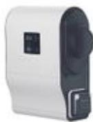
Stazione di ricarica Green Up Premium in plastica 7,4 kW (16/32 A), per la ricarica di 1 veicolo elettrico. Ricarica (MODO 2 - MODO 3). Installazione da parete o da pavimento (con piedistallo accessorio 0 590 52). La stazione deve essere accessoriata con circuito di alimentazione e dispositivi di protezione adeguati. Comunicazione locale via Bluetooth per la configurazione e la gestione tramite Smartphone con App EV CHARGE (Android o IOs - scaricabile gratuitamente dagli store digitali).
