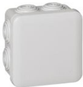
Scatole quadrate IP55. 80 x 80 x 45 mm. Con 7 passacavi art. 0919 10. Colore grigio RAL 7035. Cassetta e coperchio in polistirene. Temperature di utilizzo da -25 a +40°C. Resistente al calore anormale (autoestinguenti) T=650 °C. Entrate cavi mediante passacavi a gradini. Chiusura del coperchio a pressione. Apertura con utensile. Fornite con tappi di protezione delle viti di fissaggio a salvaguardia dell' IP.
