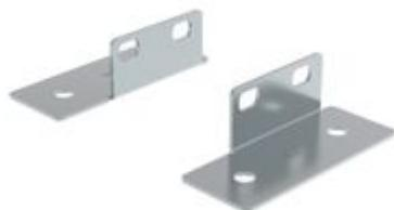
Flange per attacco a quadro. Altezza: 75 mm. Larghezza: da 75 mm a 400 mm. Finitura L: Acciaio inox AISI 316L
