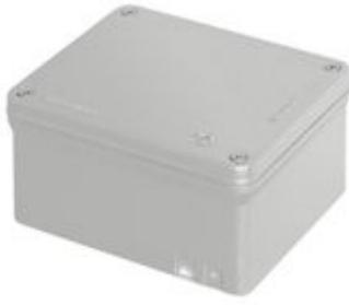
Cassetta di derivazione CT Atex 239x204x90mm (lxpxa) verniciata RAL 7035. Cassetta e coperchio in alluminio pressofuso munita di due sistemi di messa a terra, interno mediante masselli e viti, esterno mediante apposito kit; complete di viti per il fissaggio esterno del coperchio. Su richiesta è possibile avere la cassetta di un colore RAL a propria scelta, mantenendo la validità del certificato ATEX.
