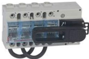
Sezionatore modulare per fotovoltaico categoria DC23A - versione 2P In= 125A - Vn= 1000Vdc. Comando rotativo
