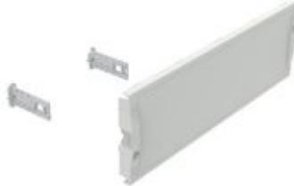
Pannello cieco altezza 150 mm per telai modulari larghezza 500 mm, per quadri Atlantic-E, Atlantic inox e Marina. Pannelli in ABS e fibra di vetro - RAL 7035. Tenuta al calore anomalo: T = 750°C. Fissaggio su supporti con viti ad 1/4 di giro
