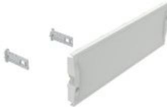
Pannello cieco altezza 150 mm per telai modulari larghezza 800 mm, per quadri Atlantic-E, Atlantic inox e Marina. Pannelli in ABS e fibra di vetro - RAL 7035. Tenuta al calore anomalo: T = 750°C. Fissaggio su supporti con viti ad 1/4 di giro
