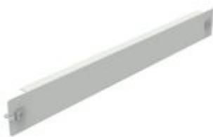
Pannello cieco altezza 300 mm per telai modulari larghezza 800 mm, per quadri Atlantic-E, Atlantic inox e Marina. Pannelli in metallo - RAL 7035. Tenuta al calore anomalo: T = 750°C. Fissaggio su supporti con viti ad 1/4 di giro
