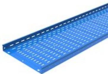
Elemento rettilineo forato imbutito MF. Altezza 50 mm. Larghezza 600 mm. Lunghezza 3 m. Finitura G: Acciaio smaltato blu Gamma-P
