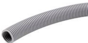
Guidacavo LGP Standard. Diametro nominale 48 mm. Diametro esterno 55 mm. Colore: grigio. Materiale PA6.6 [UL94-V2] privo di alogeni e non propagante la fiamma.
