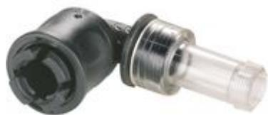
Raccordo LGP a 90° per sensore. Diametro nominale 7 mm. Filettatura M30. Colore: nero. Materiale: PA6.6 [UL94-V0] privo di alogeni e non propagante la fiamma
