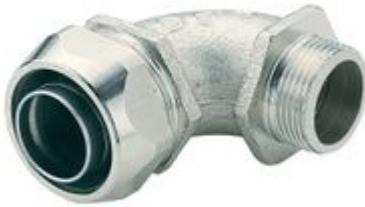
Raccordi metallici per guidacavi metallo plastici Serie 2000 Metal 90 gradi - Filettatura GAS - Diametro guidacavo interno: 34,5mm Filettatura: G1 1/4
