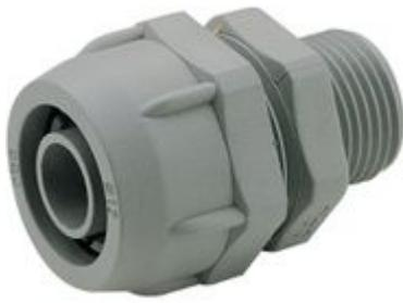
Raccordi plastici per guidacavi in PVC Universale - Filettatura ISO - Colore grigio. Diametro guidacavo interno/esterno: 39-50mm Filetto: M40x1,5
