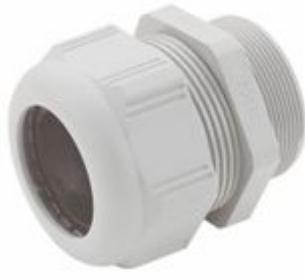
Pressacavo PSP in poliammide a serraggio meccanico con chiusura antivibrazione, completo di guarnizione interna. Colore grigio RAL7035. Filetto M40. Diametro cavi (min/max) 22-32mm.
