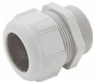
Pressacavo PSP in poliammide a serraggio meccanico con chiusura antivibrazione, completo di guarnizione interna. Colore grigio RAL7035. FilettoM50. Diametro cavi (min/max) 30-35mm.
