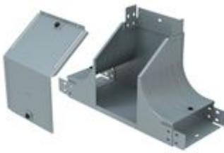
Derivazione verticale a T" in salita con variazione di piano, completa di coperchio. Altezza: 75 mm. Larghezza: 300 mm. Finitura C: Acciaio zincato a caldo dopo lavorazione.
