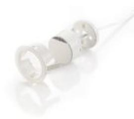
Sensore MW (Microonde), tipo MWS5 piatti mini. ON/OFF 3 A - IP 40 Sensori MW mini con modulo di gestione per montaggio da incasso a soffitto. Rilevamento 360°, portata ø 8 m Altezza di fissaggio raccomandata: 2,4 m Forniti con configurazione standard per una messa in servizio facile e veloce Il valore A indicato è valido per le lampade fluorescenti compatte e a LED Collegamento 1 x 2,5 mm<sup>2</sup> o 2 x 1,5 mm<sup>2</sup>
