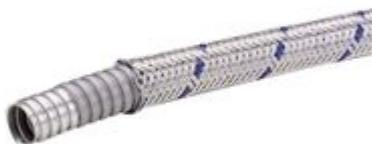
Guidacavo trecciato flessibile FTR in acciaio zincato a semplice aggraffatura rivestito in PVC aspirato con treccia esterna di acciaio zincato. Diametro interno: 21mm diametro esterno: 26
