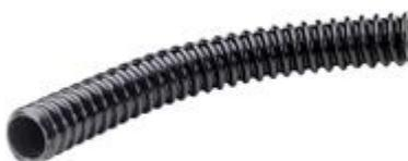
Guidacavi FX in PVC plastificato con spirale di rinforzo in PVC rigido. Superficie interna semiliscia per un miglior scorrimento cavi. Colore: nero Diametro interno: 16 Diametro esterno: 20,5
