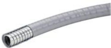
Guidacavo metallo plastico PX2 in acciaio inox a doppia aggraffatura rivestito in PVC liscio. Colore grigio diametro interno: 10mm diametro esterno: 16
