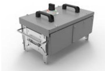
Cassetta di derivazione in metallo per installazione di interruttori scatolati MEGATIKER (non inclusi) - In= 63/125/160A - Tipo 1 - IP55 (coperchio rimovibile con dispositivo di sezionamento)
