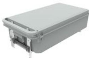
Cassetta di derivazione in materiale plastico in fibra di vetro con portafusibile per 3 fusibili NH2 (fusibili non inclusi) - In= 250A - Tipo 3 - IP55 (coperchio con dispositivo di sezionamento)
