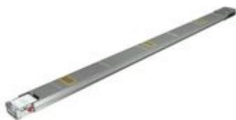
Elemento lineare XCM250 conduttori in alluminio con 3+3 finestre per lato in posizione fissa - In=250A - IP55 - lunghezza 3m
