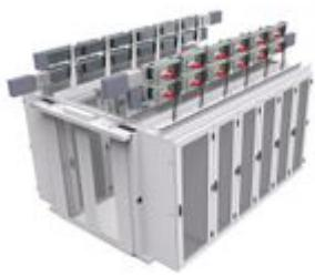
Elemento lineare XCM per data center. Conduttori in alluminio e 2 finestre per lato (passo 600mm) - In=250A - IP40 - lunghezza 1,2m
