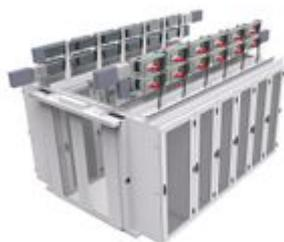
Elemento lineare XCM per data center. Conduttori in alluminio e 4 finestre per lato (passo 600mm) - In=1000A - IP40 - lunghezza 2,4m
