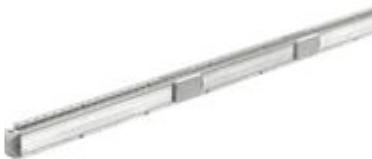
Elemento lineare LB PLUS 634 (tipo B) a 4 conduttori In=63 A - IP55 - lunghezza 3 m - 4+4 derivazioni
